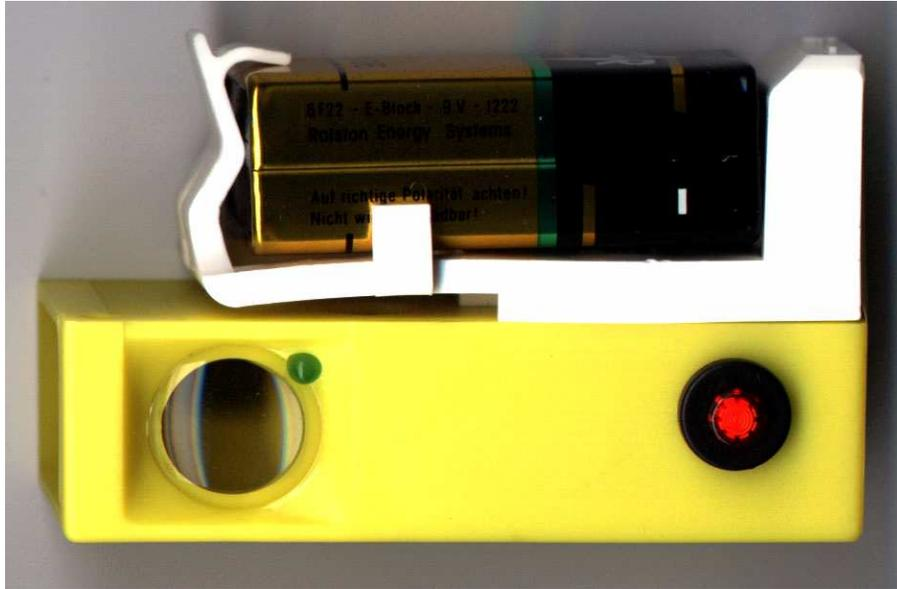
**Zur Vereinfachung und Verbesserung der Senderjustage kann der Lichtstrahl mit diesem Hilfsmittel praktisch sichtbar gemacht werden.**
